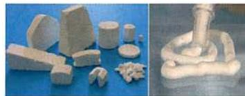
Parmi ses nombreuses innovations, citons les premiers inserts pour cage de fusion. Constitués en céramiques biphasées micro / macroporeuses, BIOMATLANTE est pionnière de cette technologie. Ces inserts précurseurs reposent sur une mise en forme des biocéramiques, un usinage et des propriétés biologiques.
